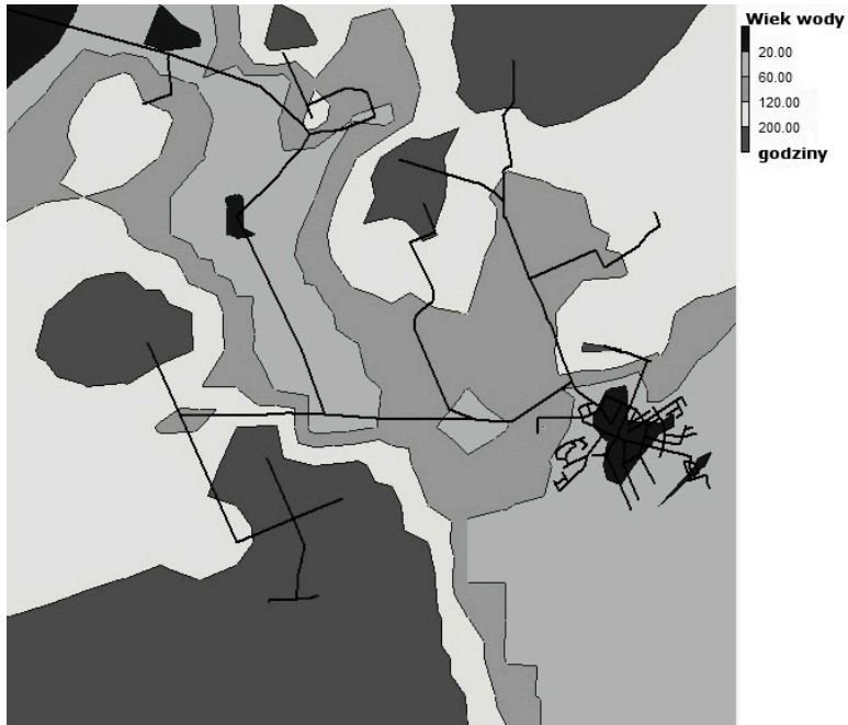
Rysunek 3. Wiek wody w badanej sieci wodociągowej w wariancie 2, symulacja 240 h
